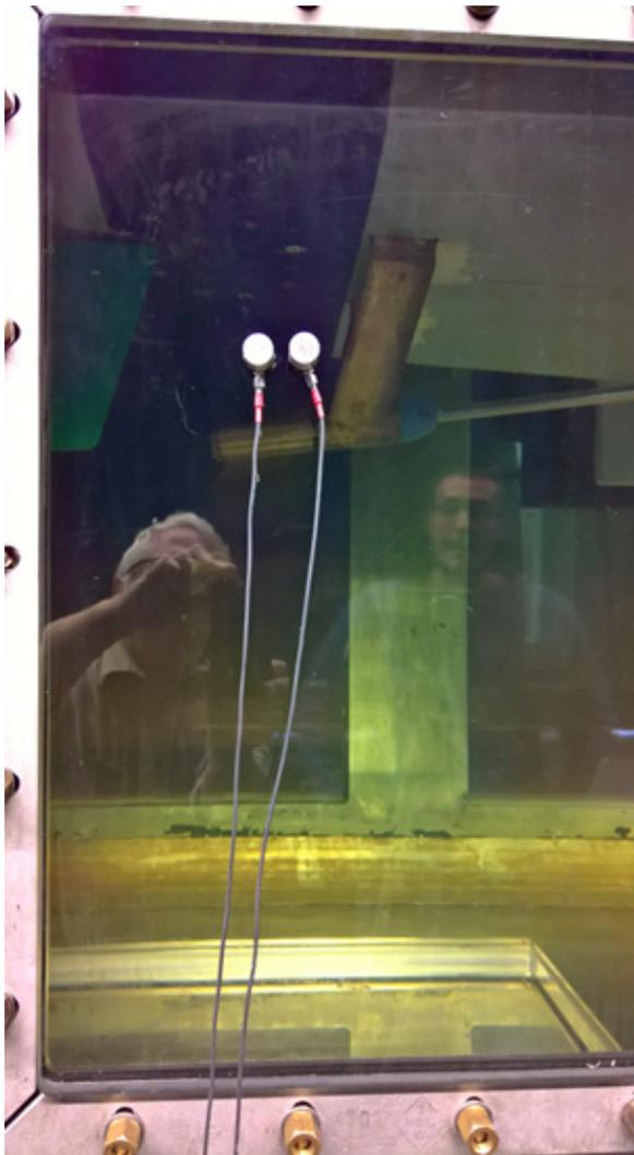
**Bild 12: Körperschallsensoren am Fenster des Kavitationstunnels**
