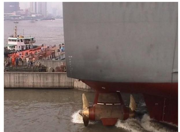
Bilder 26 - 31: Chemikalien-tanker PROSPERO mit 1 x SSP 7 (5100 kW)
